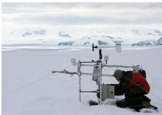
Obr. 6 – Automatická meteorologická stanice ve vrcholové části kopule ledovce Davies Dome slouží k měření teploty a vlhkosti vzduchu, směru a rychlosti větru, intenzity globálního a odraženého slunečního záření, výšky sněhové pokrývky a teploty sněhu v několika hloubkách
